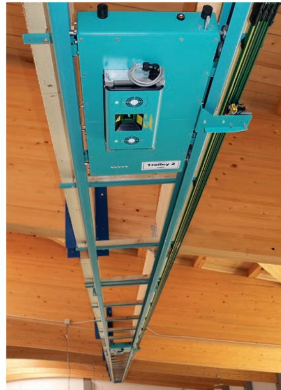
Bei der Bearbeitung extrem großer Bauteile lassen sich mehrere Projektoren auch auf Schienen unter der Decke steuern
