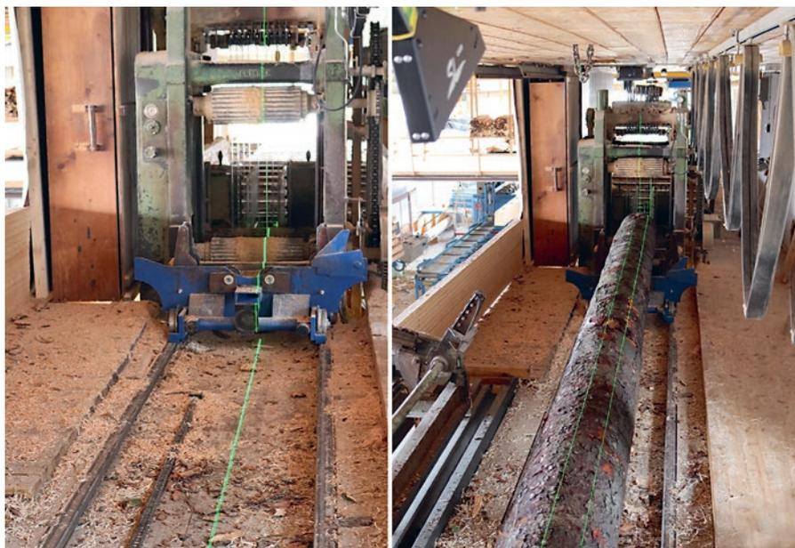
Bei Sägearbeiten werden die Schnittlinien präzise dargestellt
