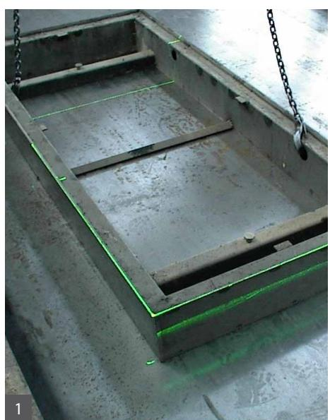
Oberkonturprojektion für das exakte Ausrichten der Schalung
