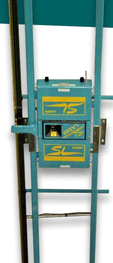
Laser an einem Schienensystem
