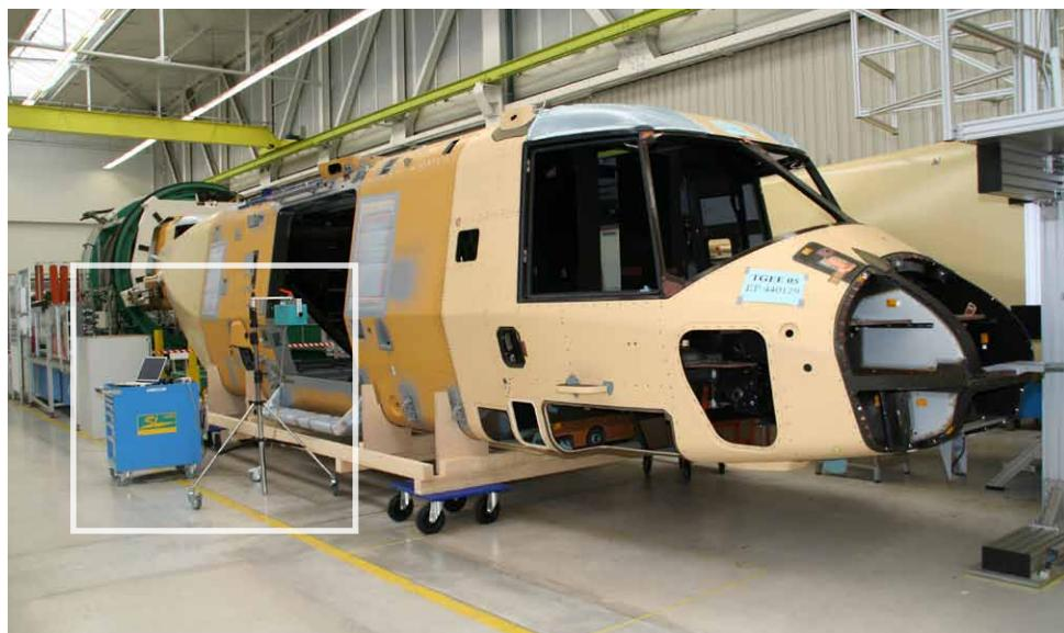
Mobiles System für die Projektion der Bauteile
